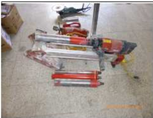
Foto 1: Extractor de núcleos marca HILTI ref. DD130 tres velocidades para brocas diamantadas de 4\"/>
