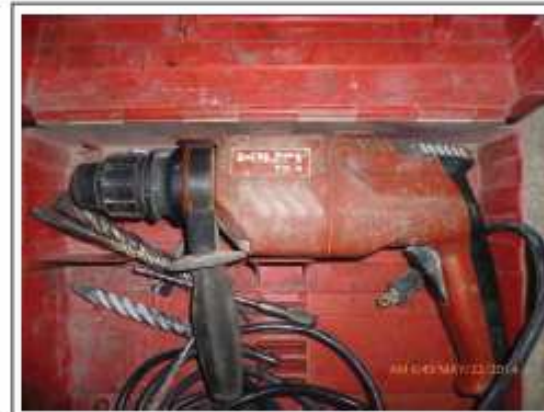
Foto 8: Taladro HILTI doble función para anclaje de soportes del extractor de núcleos.
